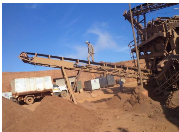
Depois - Troca do transportador (Comprimento maior).
